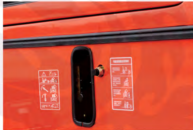
• Пыле- и влагонепроницаемая электрическая кнопка наклона: степень защиты IP67
