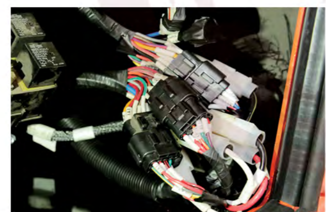
• Пыле- и влагонепроницаемые вилки и разъемы: степень защиты IP65
