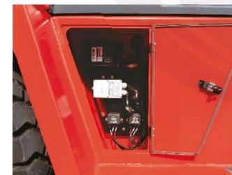
Независимый встроенный отсек электрооборудования
