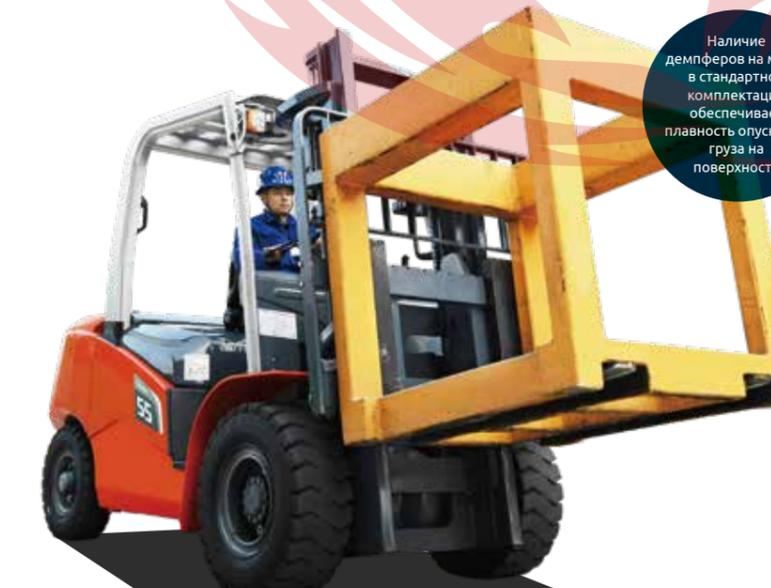
Наличие демпферов на мачте в стандартной комплектации обеспечивает плавность опускания груза на поверхность.
